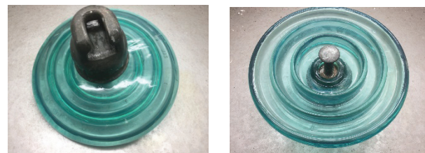
图 1 带 LSR 涂层的玻璃绝缘子
